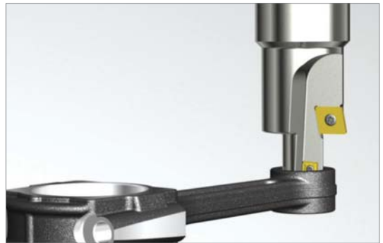
• Сверление комбинированными сверлами с СМП
