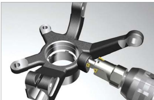
Сверление комбинированными сверлами с СМП
