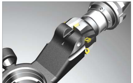
Фрезерование торца (фреза типа Future Mill)
