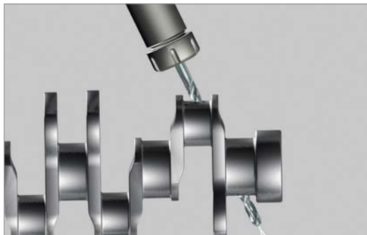
Сверление отверстия под штифт (сверла MLD)
