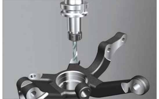
Сверление сверлами с внутренним подводом СОЖ (серия Mach Drill)
