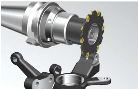
Фрезерование паза (прорезная фреза типа SPB)
