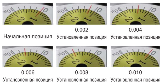
2μm точность настройки
