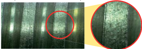
DST22 ( v_c = 100\text{ м/мин} ) Отличная обработанная поверхность
