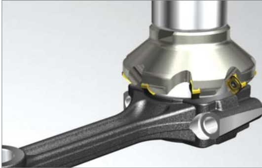
• фрезерование фрезы серии Rich Mill (RM8)
