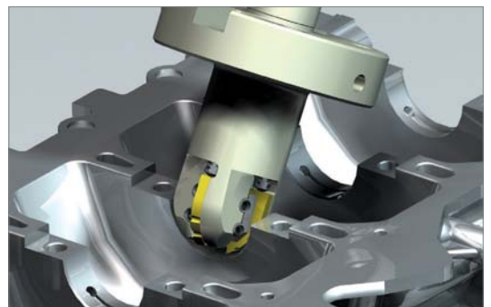
Фрезерование посадочных мест под подшипники
