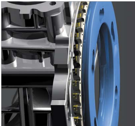
Фрезерование боковых плоскостей (Фреза серии Cube Couple mill)
