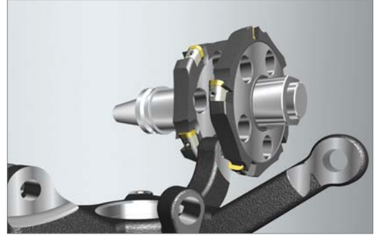
Фрезерование набором дисковых фрез
