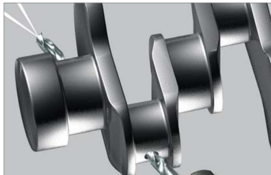
Сверление отверстий в шейках коленвала
