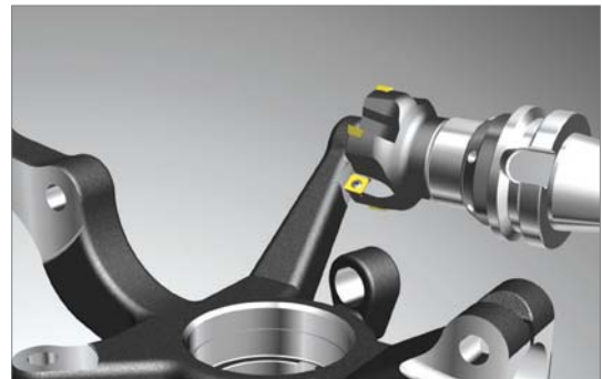
Фрезерование торца (фреза типа Future Mill)
