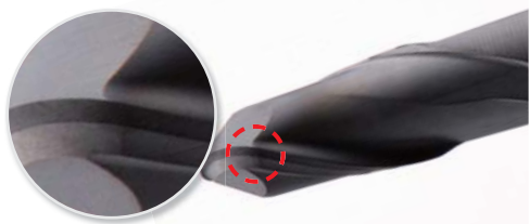
Тангенциальная форма режущей кромки
